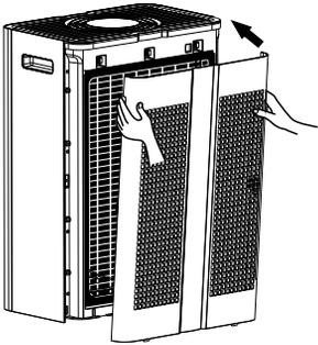
4. 调整好新滤网的方向对应上净化器上的滤网槽，并安装好滤网；然后捉住门盖扣手，门盖底部对准主机底部的凹槽后再合上门盖，插上电源开机即可运行
