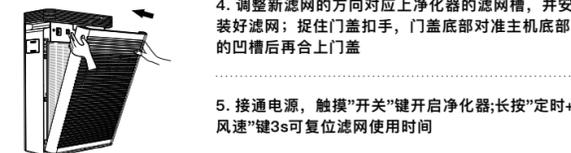
4. 调整新滤网的方向对应上净化器的滤网槽，并安装好滤网；捉住门盖扣手，门盖底部对准主机底部的凹槽后再合上门盖
