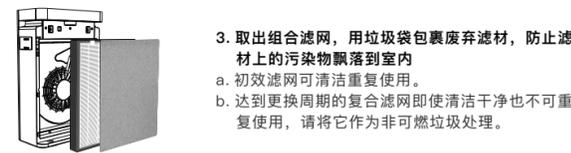
3. 取出组合滤网，用垃圾袋包裹废弃滤材，防止滤材上的污染物飘落到室内
