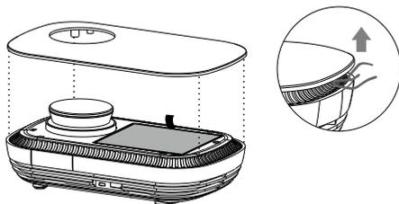
第二步：拉取滤网顶端的布带条，缓慢取出需更换的滤网(请将废弃滤网用垃圾袋包裹起来，防止滤材上的污染物飘落到室内)。
